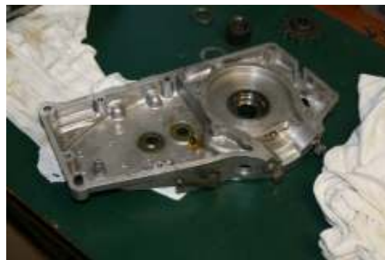
De två bulorna i växellådan är svetsade plus en del som ligger nedåt.
