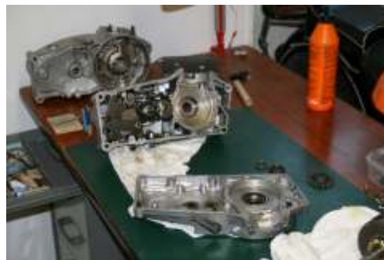
Annan blockhalva under montering. Den gamla i bakgrunden.
