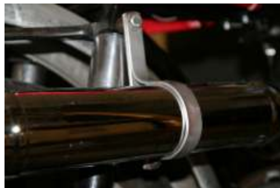
Mitt egentillverkade ljuddämparfäste.
