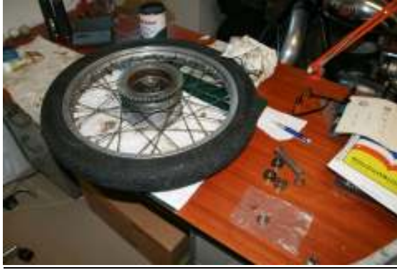
Bakhjul under byte av lager.
