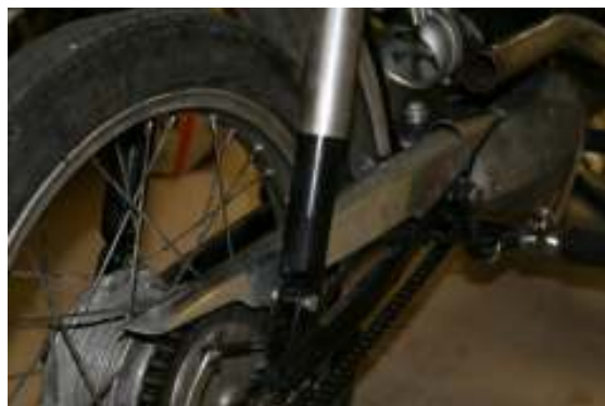
Kedjeskydd i original med min nytillverkade del närmast motorn.
