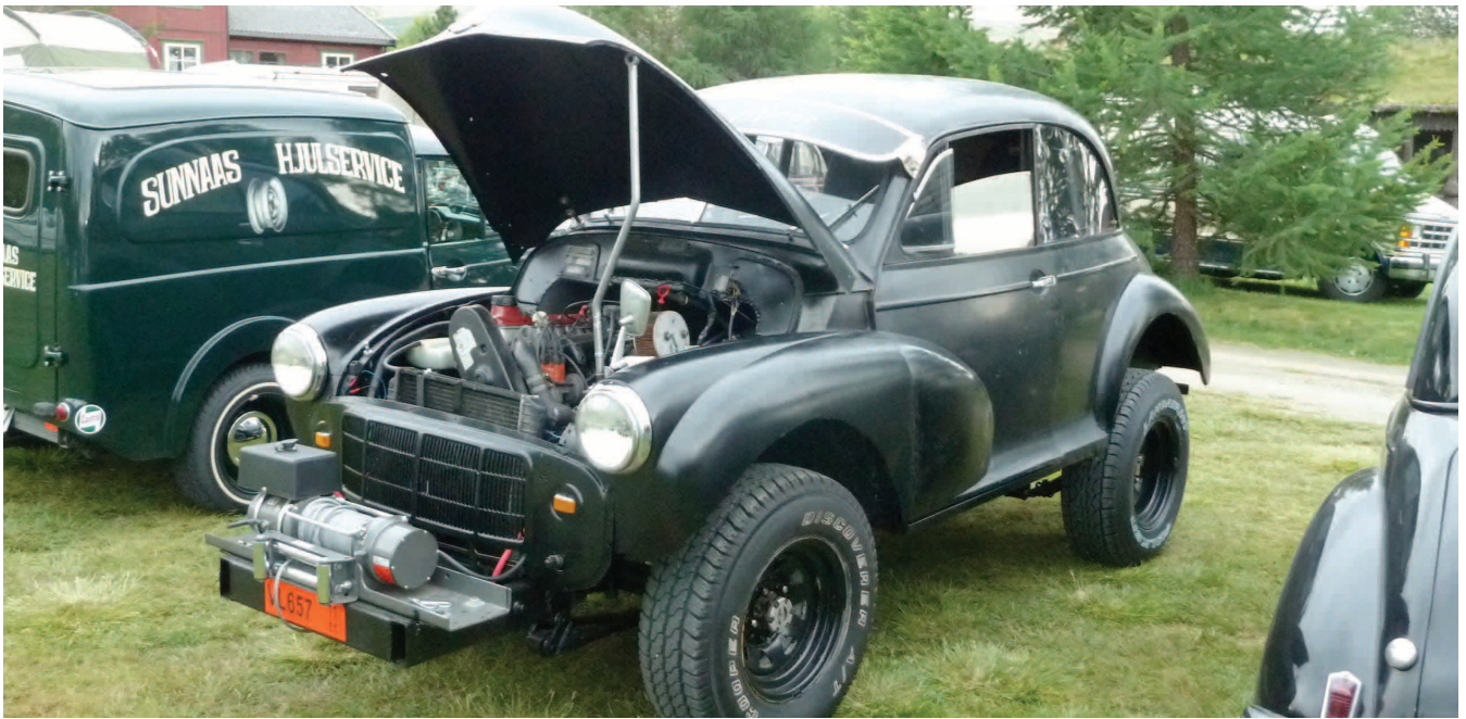
På träffen så rullade detta Norgebyggda monster in till deltagarnas stora förtjusning in. En Morris Minor 1000 med Volvo B 21 motor och vinsch.
