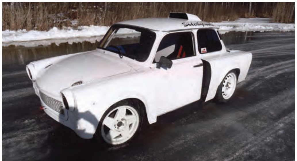
En Trabant med Volvo 850 motor monterad i "baken"
