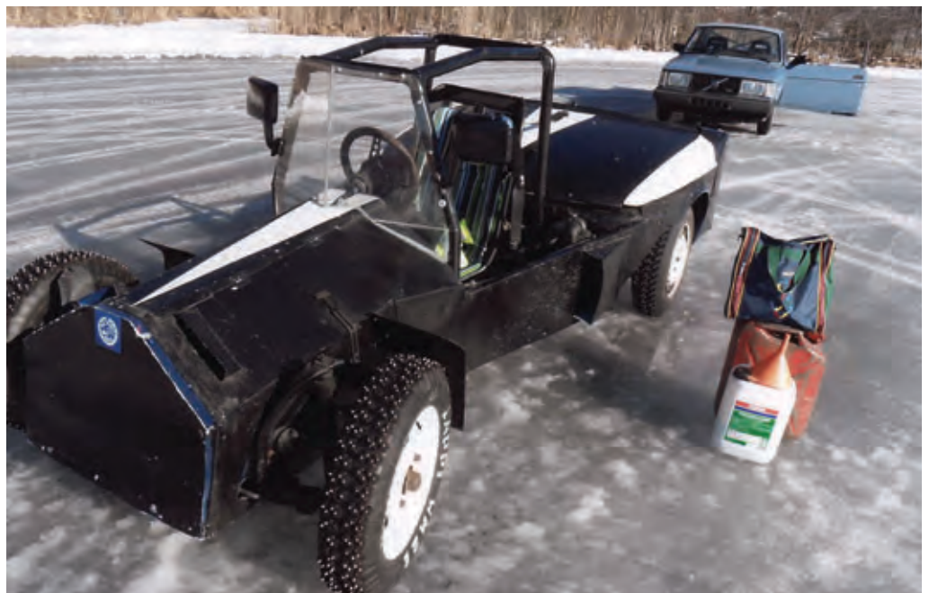
Saab 900 ombyggd till isbil, motorn monterad i "bakändan".
