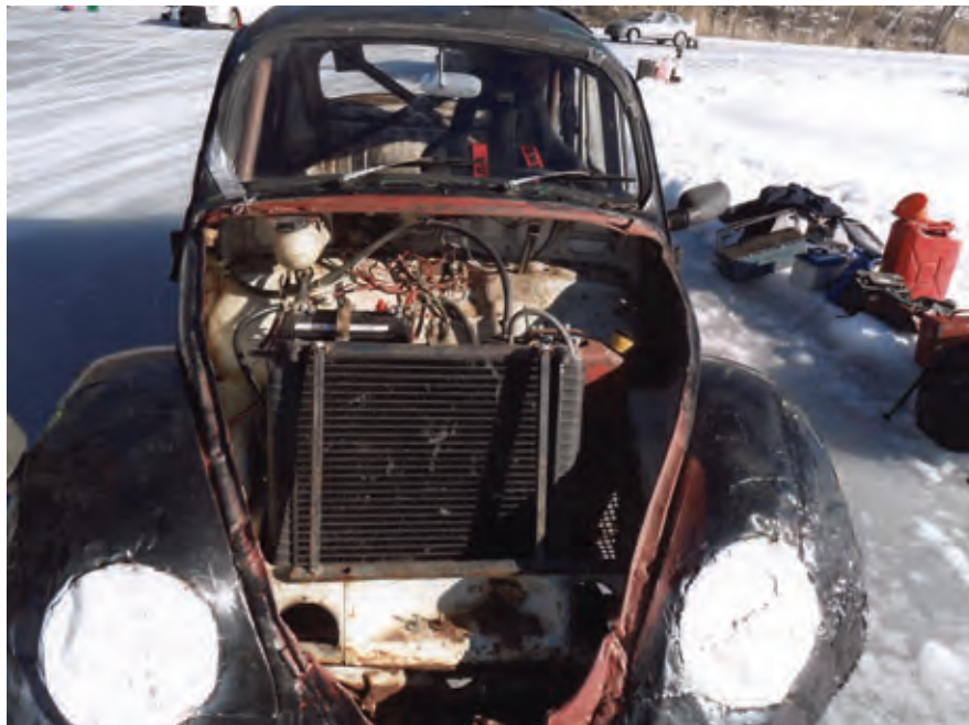
Öppnar man luckan på en ”Bubbla” hittar man vanligtvis reservhjulet. Här hittar man en kylare. Isbilen har nämligen en trimmad Opelmotor i ”baken”.
