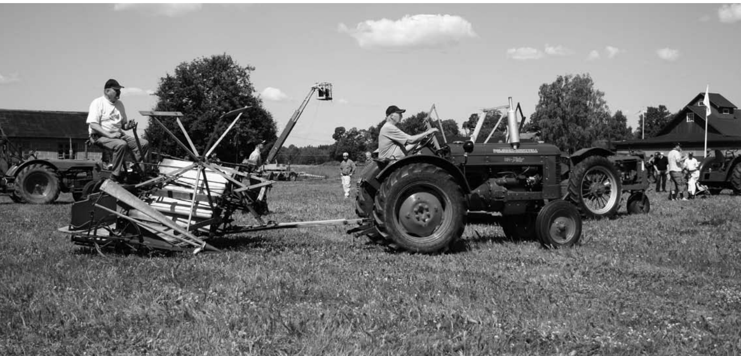
Självbindare, en så kallad "lättbindare" tar hand om säd och krävde två personer, en på BM Victor-traktorn satt Tage Karlsson och Jan Lindström som skötte spakarna på bindaren bakfefer.
