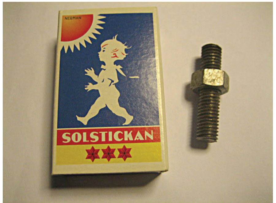
Den 19 mm långa M8 pinnbulten, som håller skyddsplåten mellan grenröret och oljetanken, gängade ur och orsakade så mycket oljud att Upplandsrundan avbröts.
