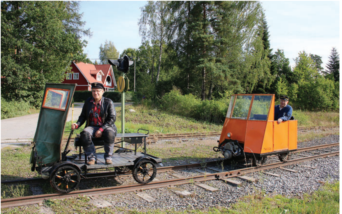
”Servicedressinen Vallvikaren” kommer från Hå-Vallviks järnväg, tillverkad någon gång på 1920/30-talet. Den körs med en tvåtakts tvåcylindrig boxermotor som är fläktkyld och har snörstart. Den orange dressinen nummer 112 från 1950 som för tillfället körs av Lennart Gunger.
