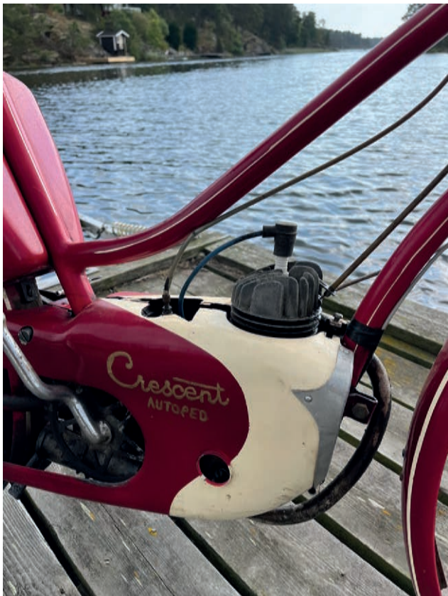
Den remdrivna Attan bestyckades med en 31 cc-motor; vackert inkapslad i en omiskännelig motorkåpa å la Crescent.
