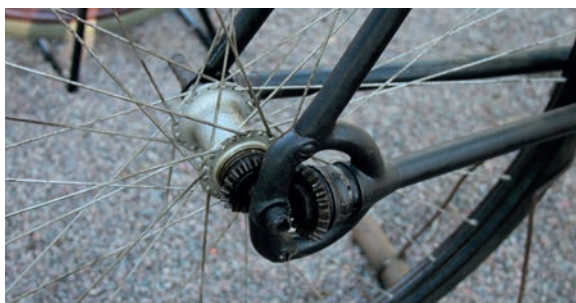
Udda trampcykel med s.k. kardandrift
